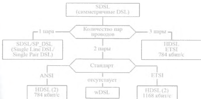
Рис. 5.1. Классификация симметричных технологий xDSL
