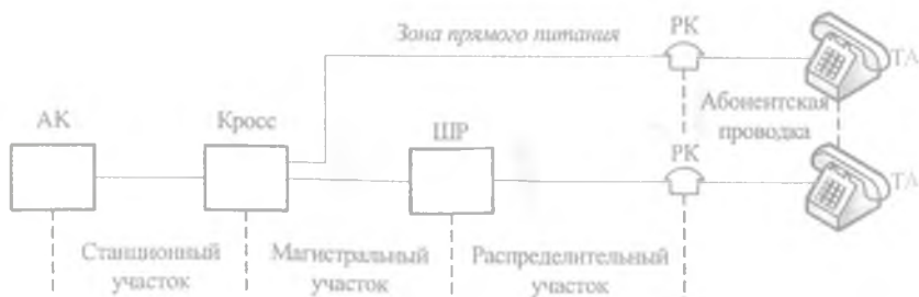
Рис. 1.1. Структура сети доступа на ГТС
