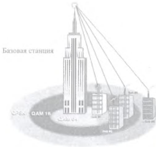
Рис. 4.5. Адаптация скорости передачи к характеристикам среды передачи
