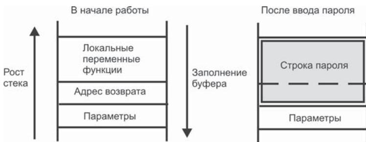
**Рис. 6.12.** Простейшая уязвимость, связанная с перекрытием стека массивом
