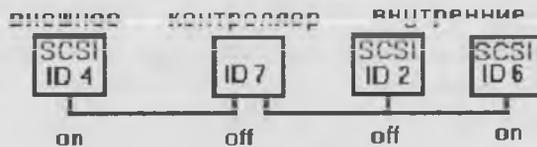
Рис. 11.3. Второй вариант подключения нескольких устройств
