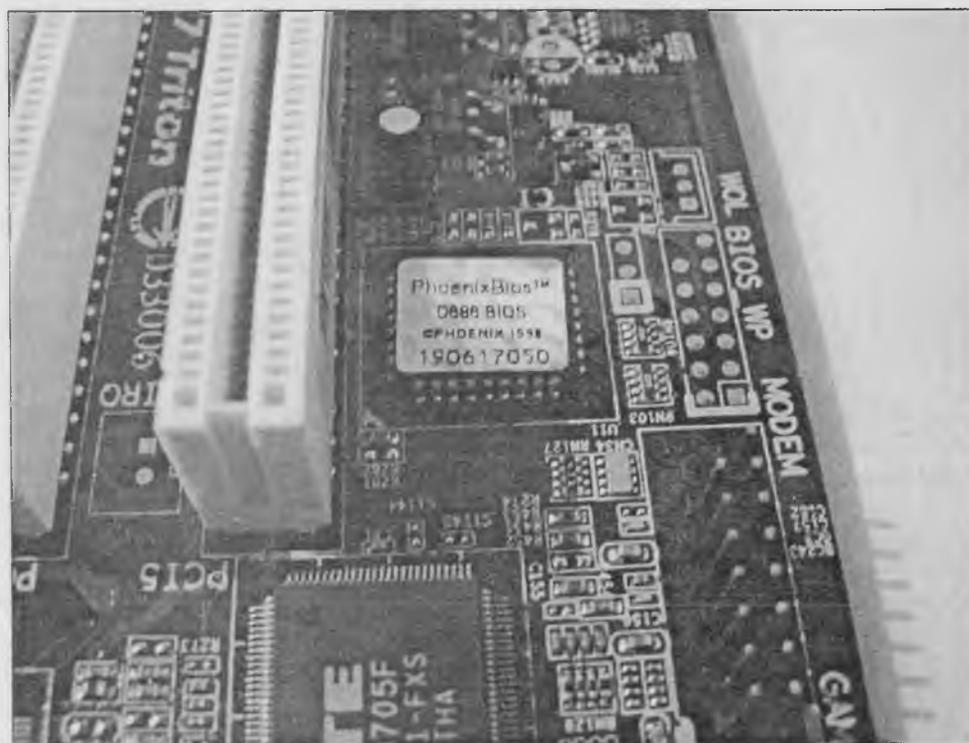
Рис. 3.2. Фактически BIOS — это всего лишь микросхема постоянной памяти
