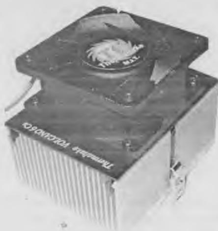
Рис. 1.7. Система охлаждения современного процессора по размерам превосходит его в несколько раз
