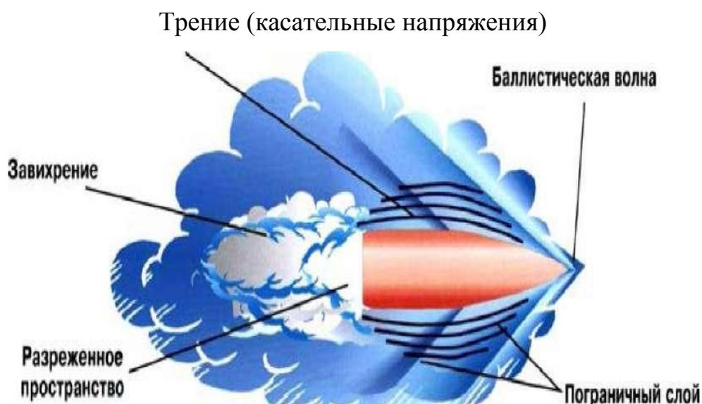
Рис 2.3 Образование силы сопротивления воздуха
