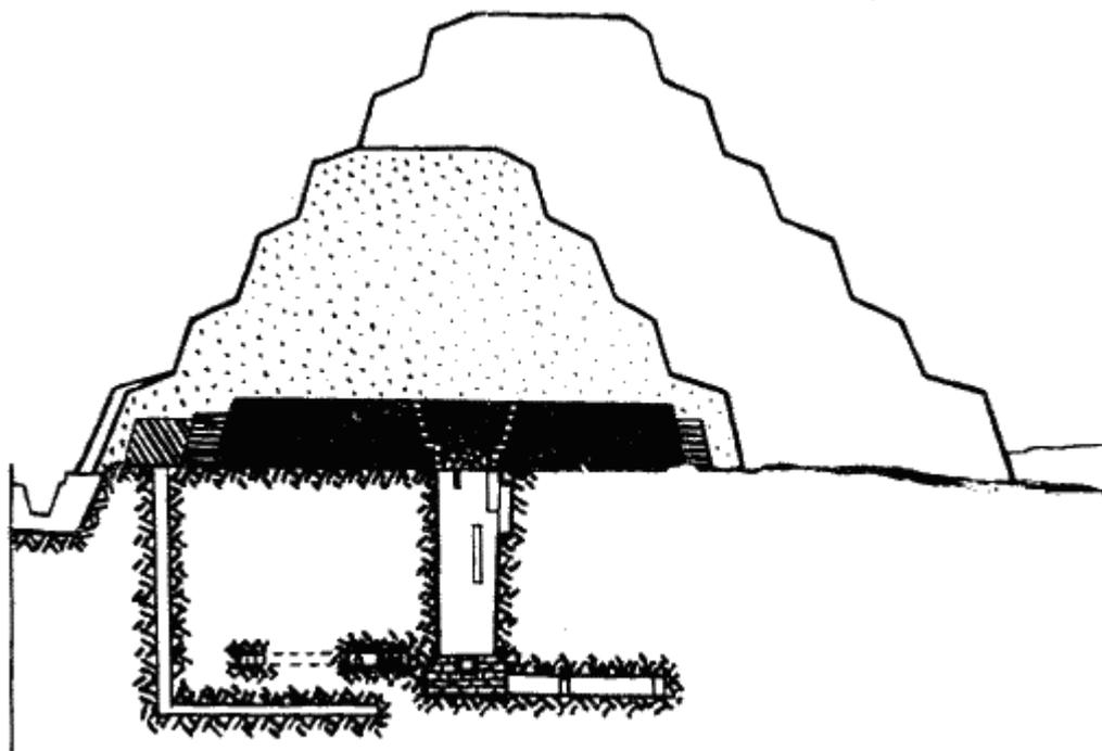
Рис. 19. Последовательные этапы строительства ступенчатой пирамиды
