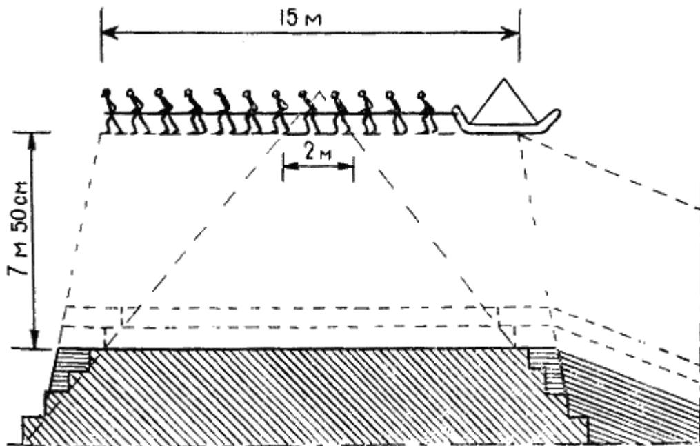
Рис. 37. Предполагаемый способ сооружения верхушки пирамиды
