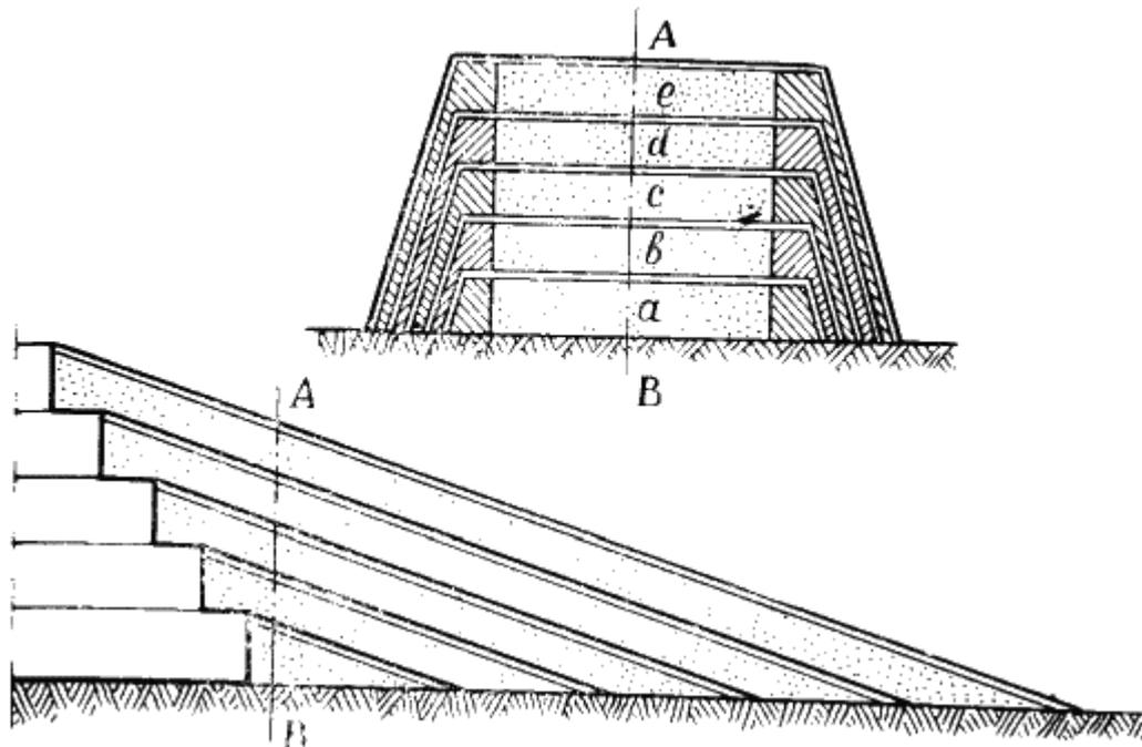
Рис. 35. Схема наращивания насыпи (по Кроону)
