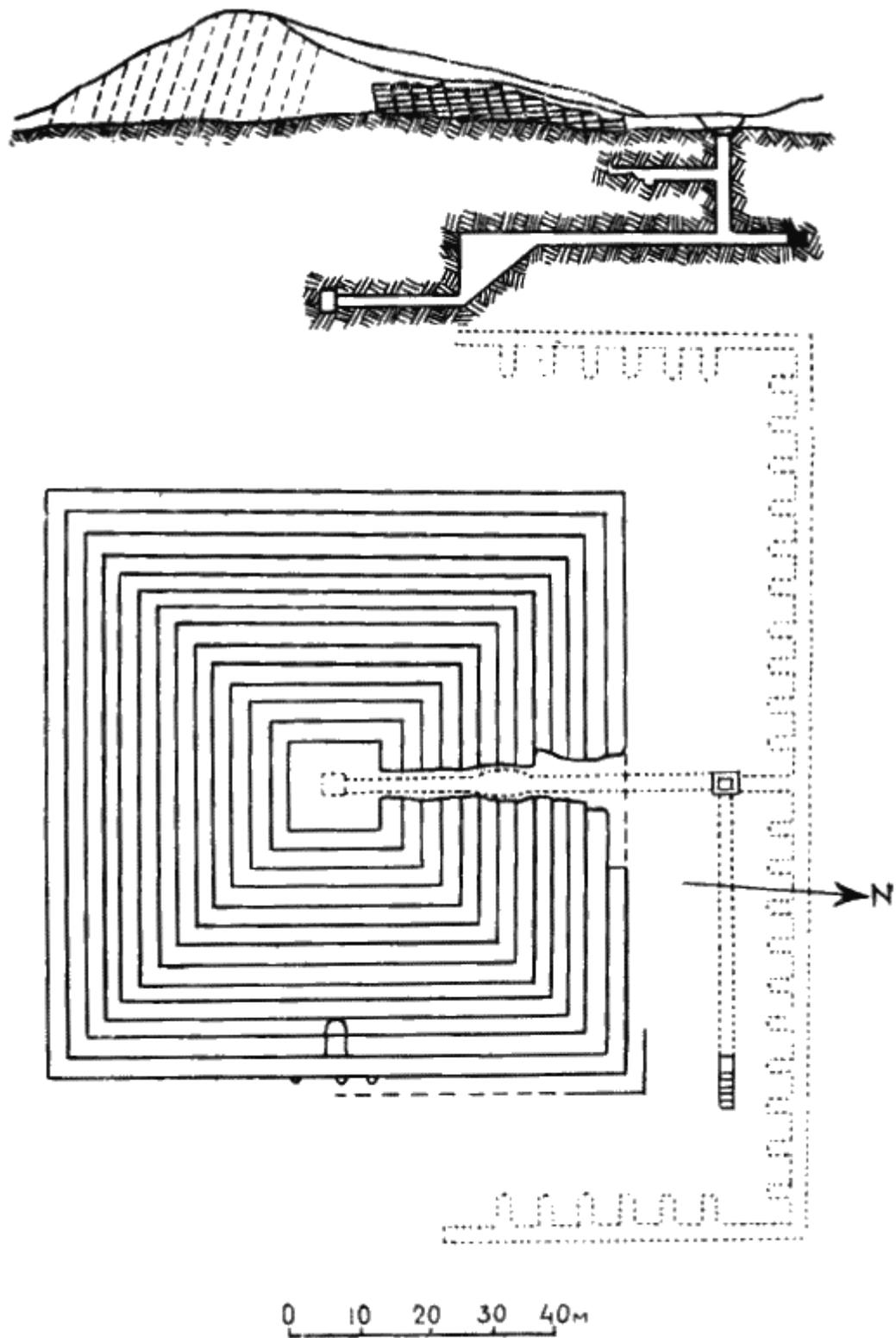
Рис. 12. План и разрез пирамиды в Завиет-эль-Ариане (по Рейснеру)
