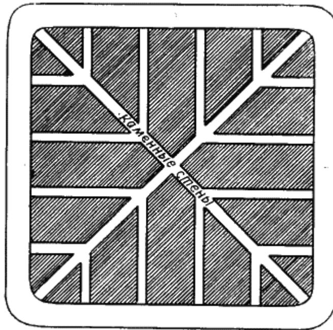
Рис. 22. Схема конструкции пирамиды в Лахуне
