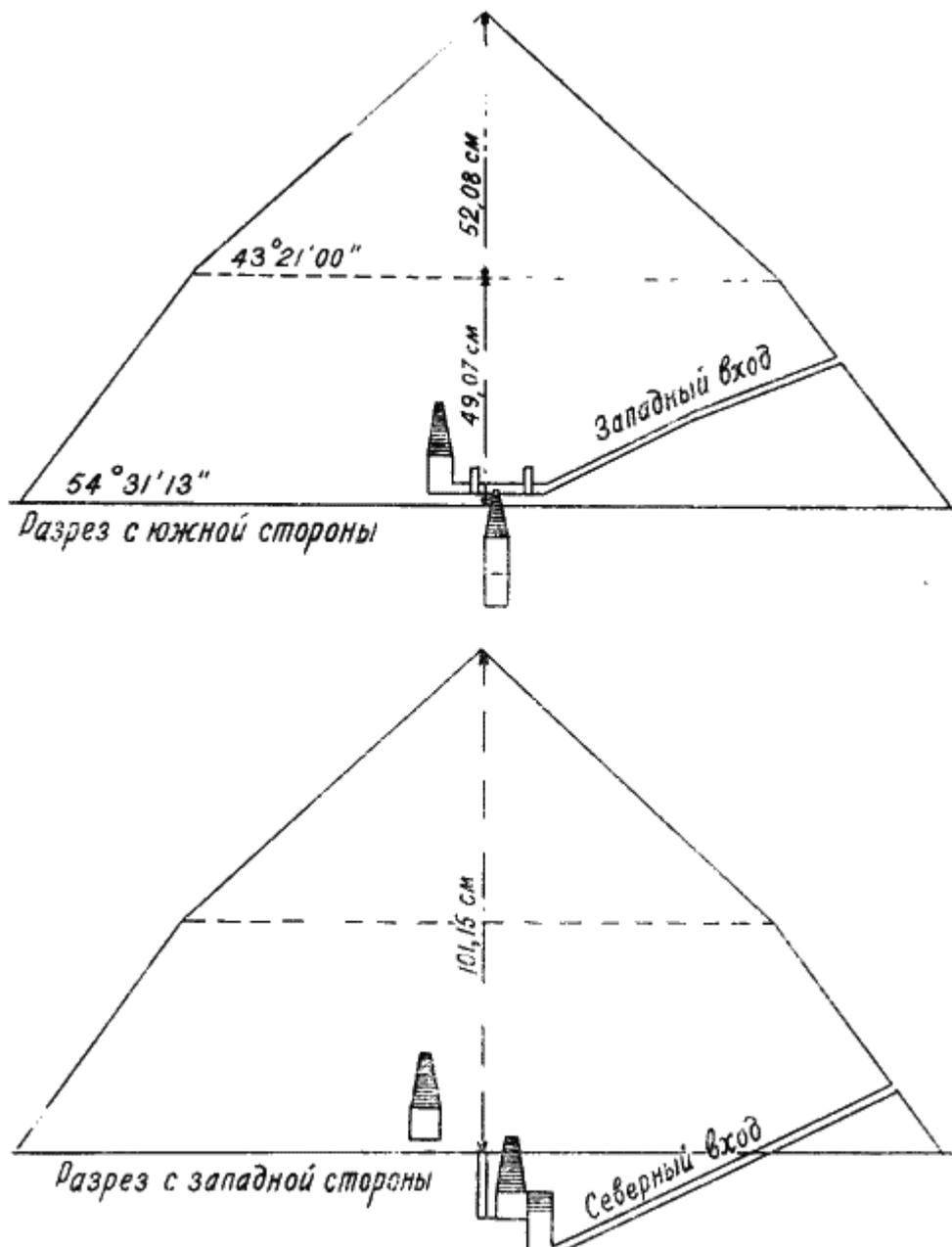
Рис. 10. Разрез «ромбовидной» пирамиды в Дашуре
