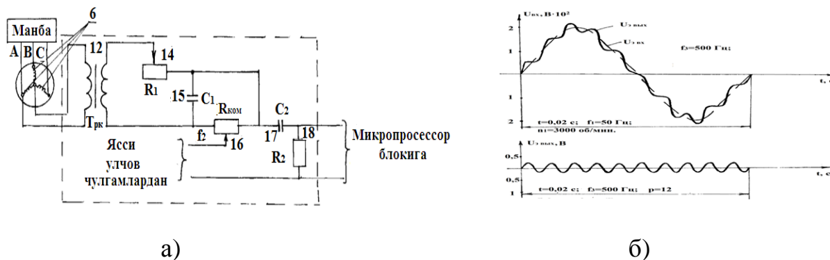
18-расм. Реактив қувват динамик манбасини айланиш тезлигини назорат қилиш ва бошқариш чизмаси (а) ҳамда ясси ўлчов чулғамли токни кучланишга электромагнит ўзгартгичларнинг чиқиш таснифлари (б)
