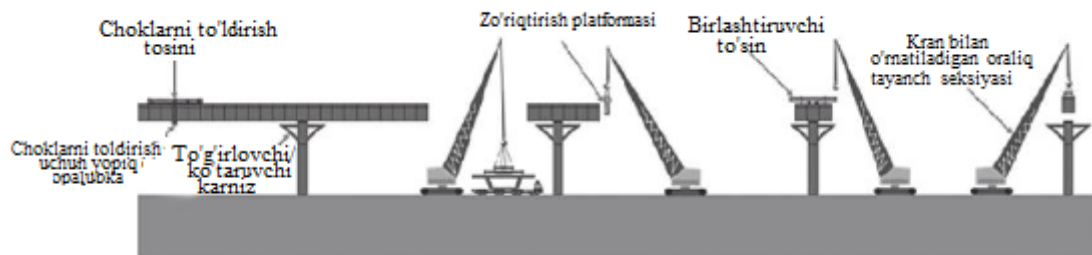
Rasm 12.52 Muvozanatlashtirilgan usulda kranlar yordamida qurish
