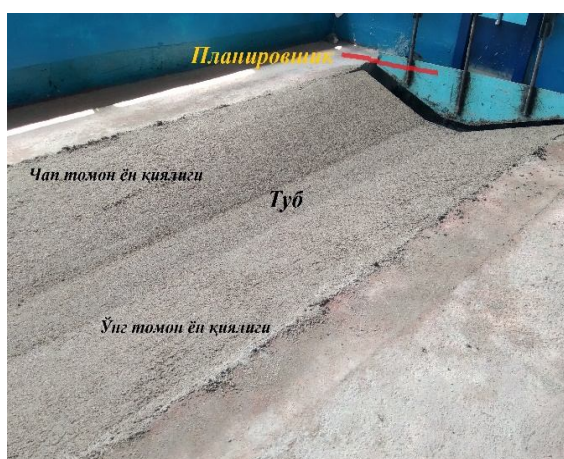
4-расм. Боғланмаган грунтли трапецеидаль канал модели
