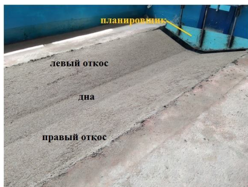
Рис.4. Модель трапецеидального канала из несвязного грунта
