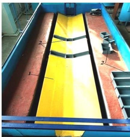
2-расм. Трапецеидалъ каналнинг модели: 1 – ёғоч канал; 2 – металл қутилар
