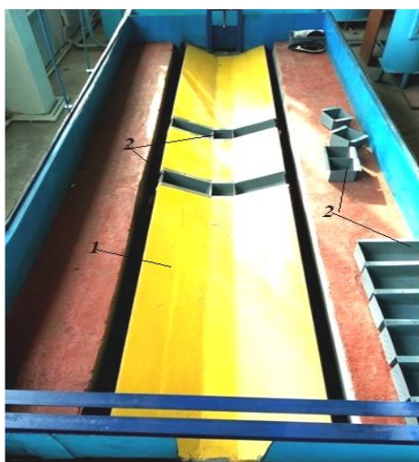
Рис.2. Модель трапецеидального канала: 1- деревянный канал; 2 - съемные металлические коробки
