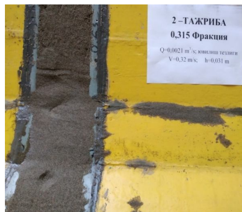
3-расм. Боғланмаган грунтнинг ювилиши
