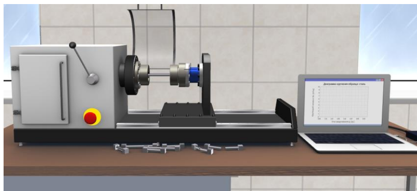
Рисунок 3. Общий вид установки для создания деформации кручения
