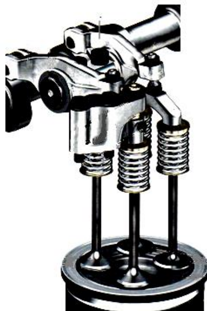
4.9-расм. Цилиндрнинг юқорисида учта клапаннинг жойлашуви.
