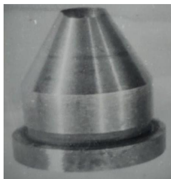
13-расм. Совуқ ҳолда штамплашда ортиқча чиқиб қоладиган металл ёки қотишмани кесадиган матрица ХЗ
