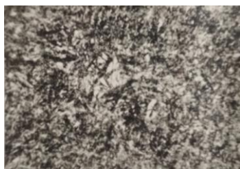
7-расм. Термоцикли термик ишлов беришнинг тўлиқ циклидан ўтган У10 маркали пўлатнинг микроструктураси
