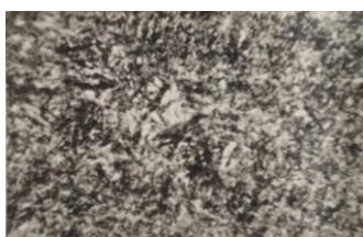
Рис.7. Микроструктуры стали У10 прошедшей полный цикл термоциклической обработки. Вторая закалка с температуры 780^{\circ}\text{C} . Окончательный отпуск 180^{\circ}\text{C}
