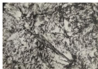
7-расм. Термоцикли термик ишлов беришнинг тўлиқ циклидан ўтган У10 маркали пўлатнинг микроструктураси
