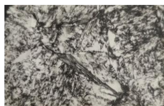
Рис.7. Микроструктуры стали У10 прошедшей полный цикл термоциклической обработки. Вторая закалка с температуры 780^{\circ}\text{C} . Окончательный отпуск 180^{\circ}\text{C}
