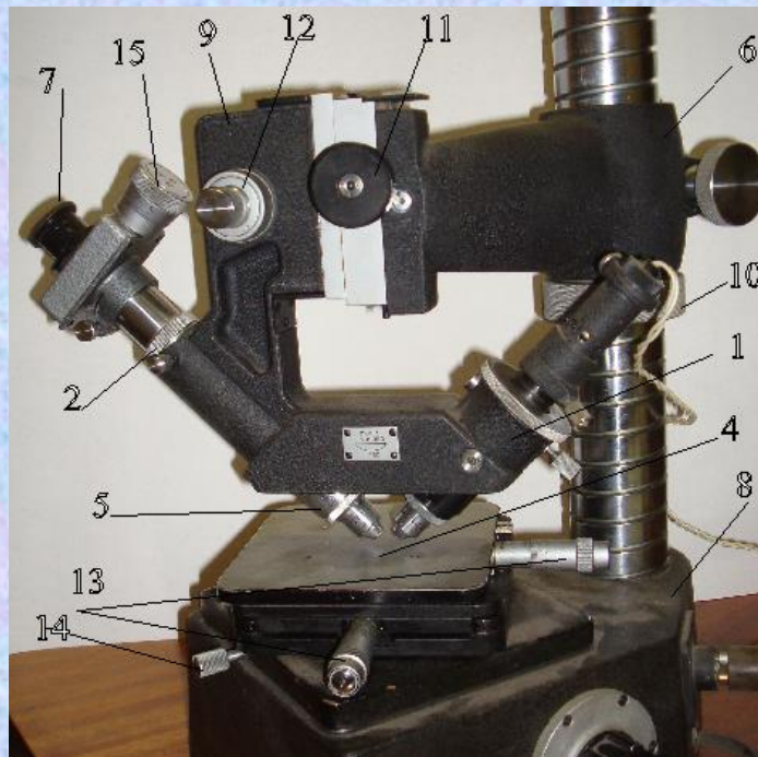
4.1-rasm. Ikkilangan mikroskop MIS-11. 1,2,3,-mahkamlash vinti, 4-buyum stoli, 5-obektiv, 6-kronshteyn, 7-vintli mikrometr, 8-taglik, 9-tutqich, 10-mahkamlash gaykasi, 11,12-maxovik, 13-mikrometrik galovka, 14-fiksatsilovchi vint.
