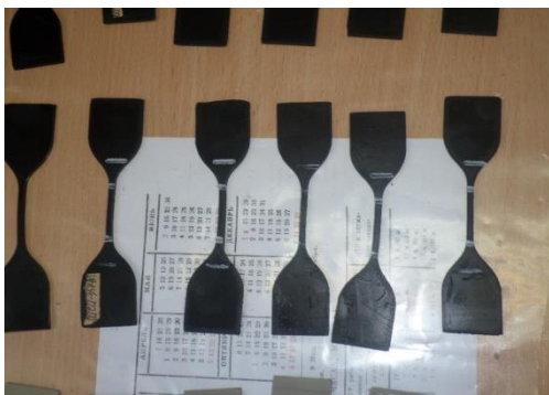
Rasm-1.4.4. Labaratoriya tekshiruvlari uchun maxsus kesilgan lapatkachalar.
