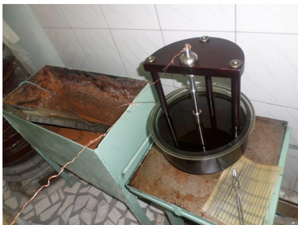
Rasm-1.4.2. Rezinaning elektr o'tkazuvchanlik xossasini aniqlash
