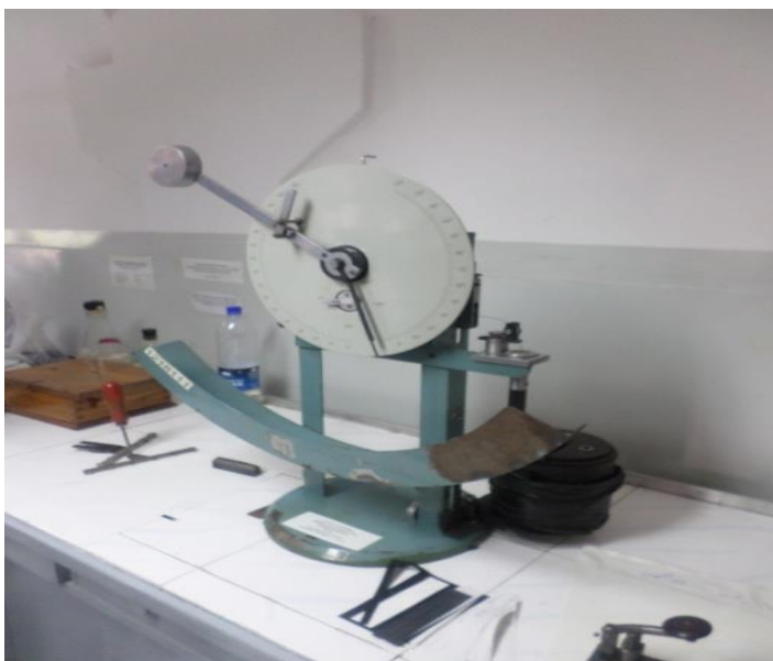
Rasm-1.4.3. Rezinani sovuqbardoshlikka tekshiruvchi laboratoriya uskunasini.
