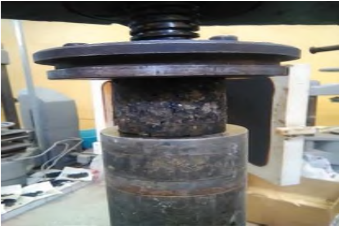
2.8-rasm Harorat va namlikning turli kompozitsiyalar namunalarining kuchiga ta'siri
