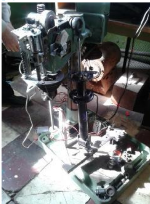
3.6-rasm. Siqish va qaytarilish kuchiga amortizatorlarni o'rganish uchun korxonada ishlab chiqarishni eksperimental o'rganish
