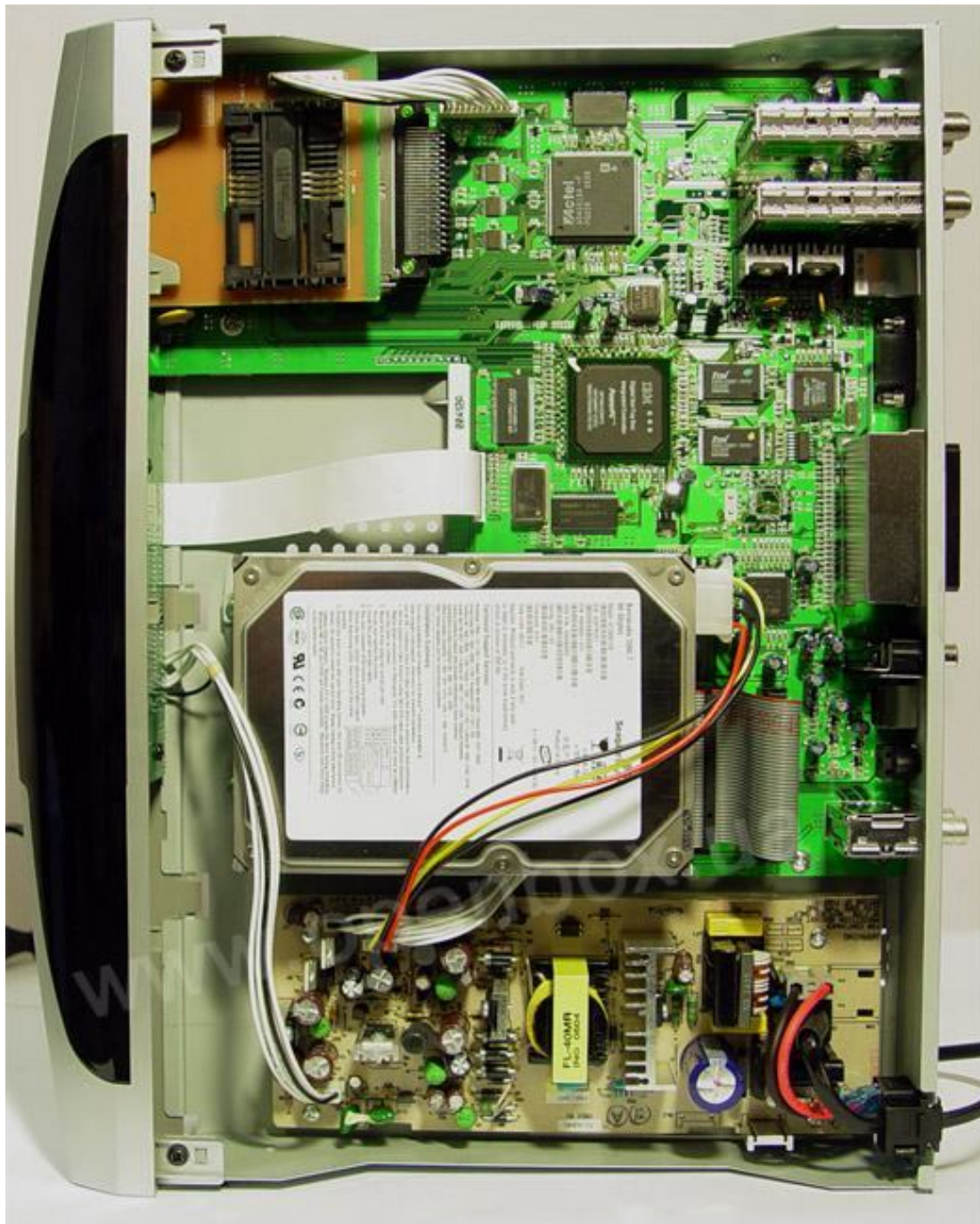
Рис. 4.25. Внутренние блоки ресивера
