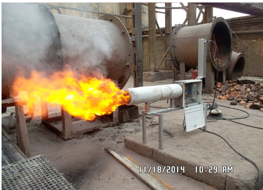
Рис.9. Сжигание водо-угольно - топливной суспензии (ВУТС) в топке сушильной печи Ангренской ЗИФ АО «Алмалыкский ГМК» с использованием факельной горелки мощностью 100 кВт/ч
