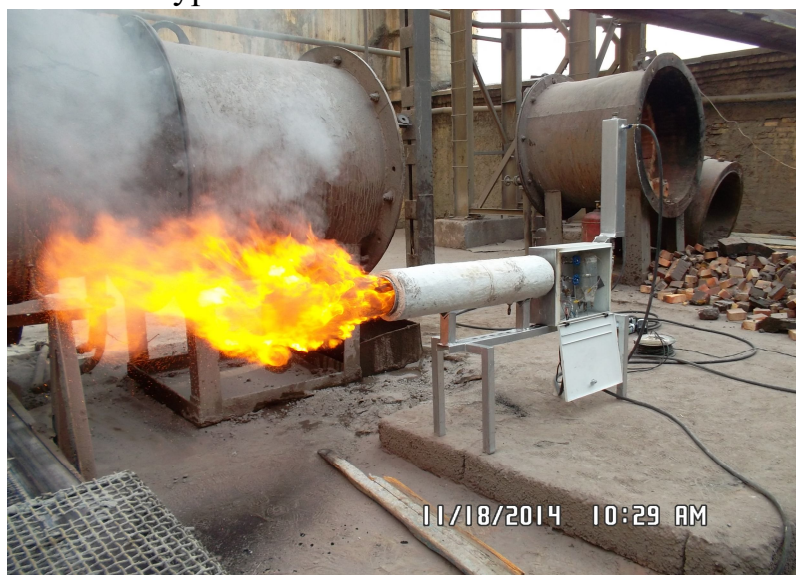
9-расм. Олмалиқ КМКнинг нодир металлар концентратларини қуриш цехи ўчоғида 100 кВт/с ли факел горелкаси ёрдамида СКЁС ёқилғисини ёниш жараёни
