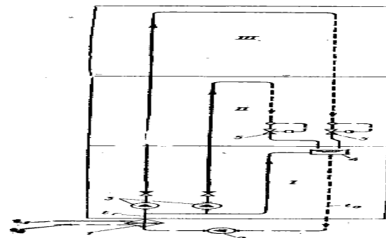
Рис. X.4. Принципиальная схема единой системы водо-водяного отопления высотного здания
