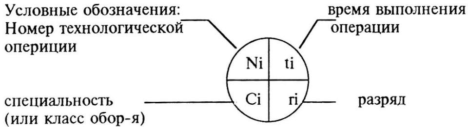
Рис.1. Обобщенный граф процесса изготовления швейного изделия.
