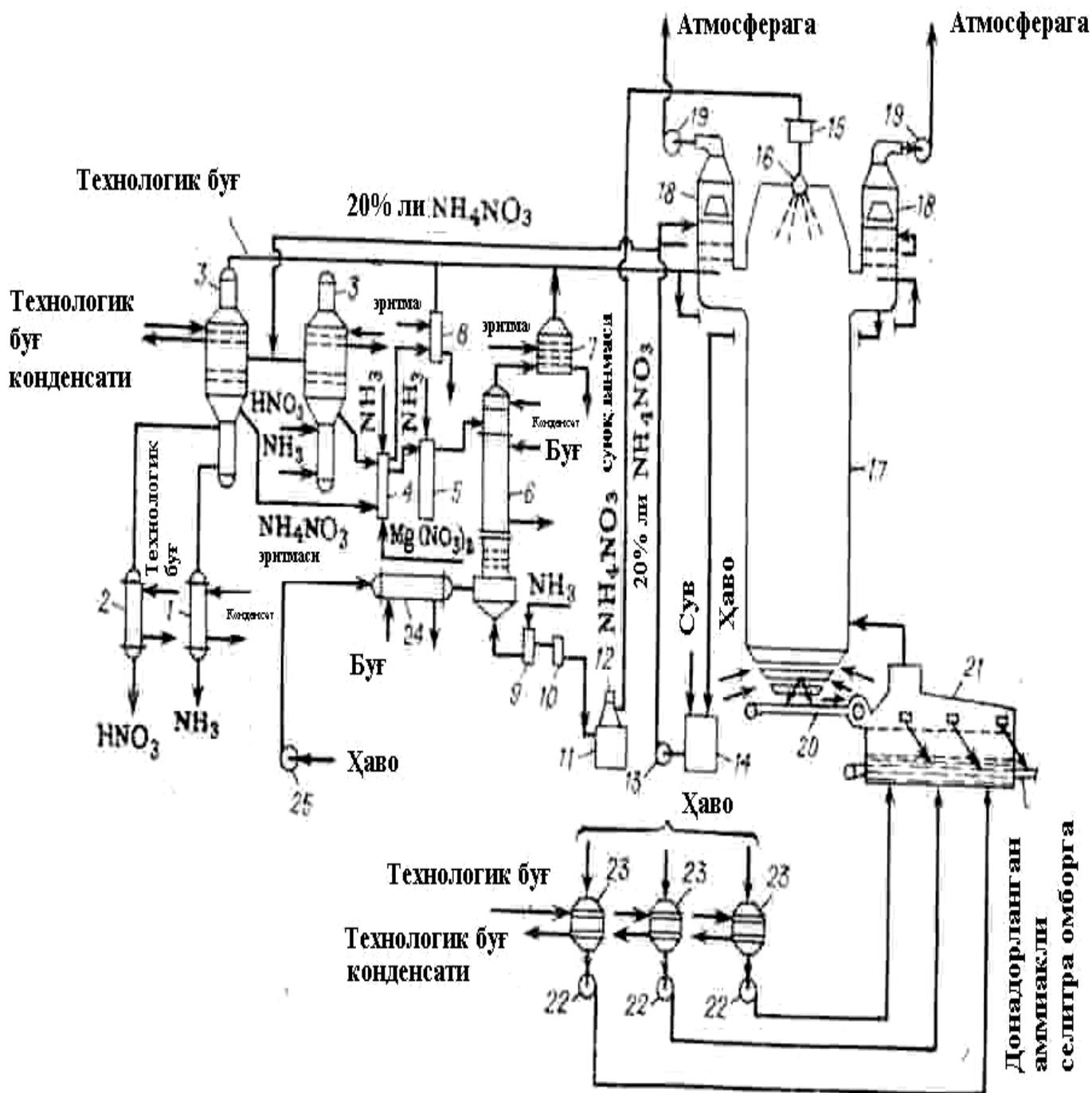
5.6 – rasm. AS-72M qurilmasining texnologik sxemasi:
