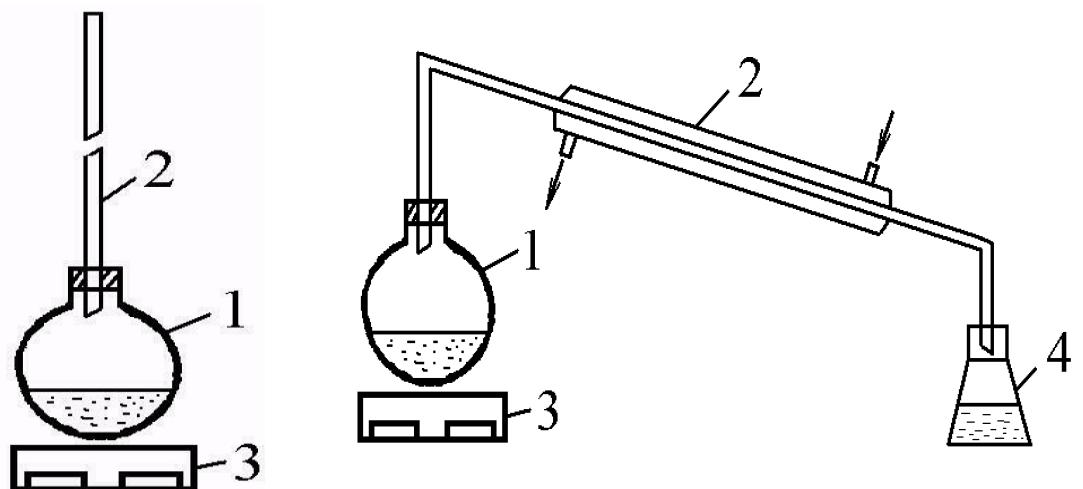
Rasm. Sirkas kislotasidan efir olish qurilmasi.
