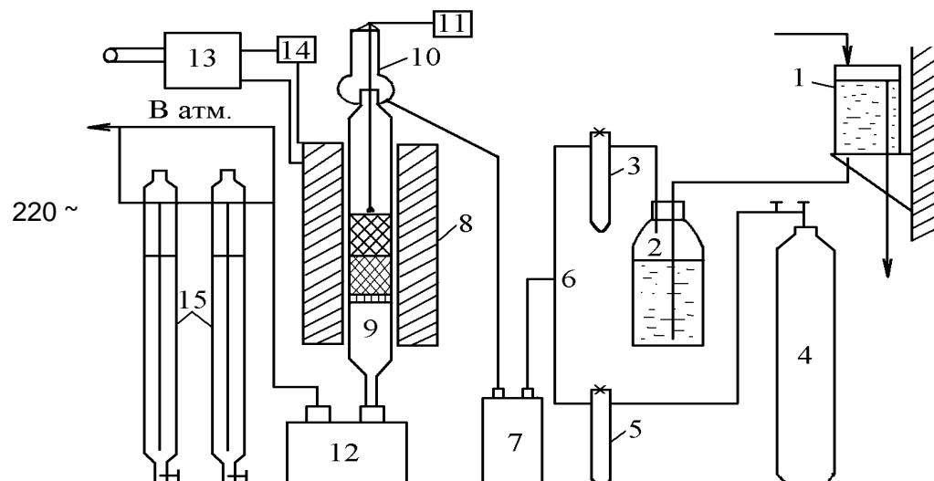
Rasm. Ammiakni oksidlash va nitrat kislotasi olish qurilmasi
