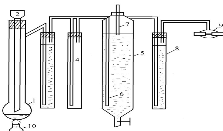
Rasm. Xlorid kislotasi olishni laboratoriya qurilmasi.
