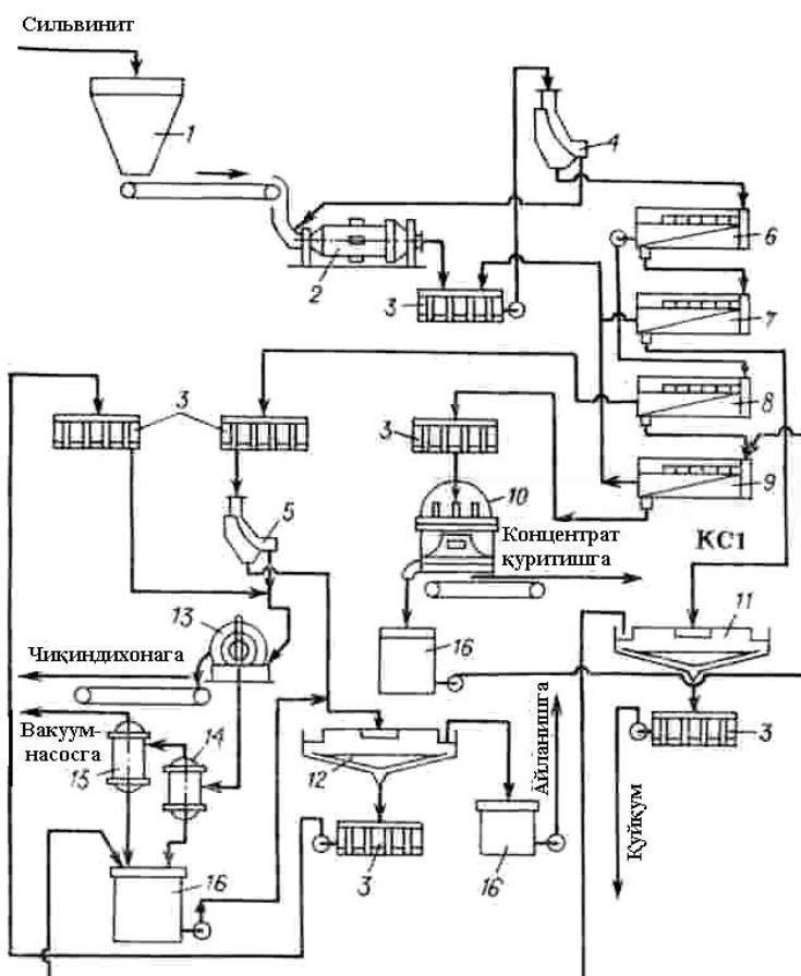
17.4 – rasm. Oldindan tuproqli quyqum flotatsiyalangan silvinitdan kalyxlorid ishlab chiqarishning flotatsiyali usuli sxemasi.
