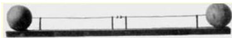
17-súwret. Gertsdiń birinshi radiatorı. Gerts induksion katushkaga jalǵanǵan eki metrli sımlardan paydalanǵan.
