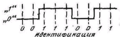
Рис. 27. Интерпретация битов при синхронной передаче данных
