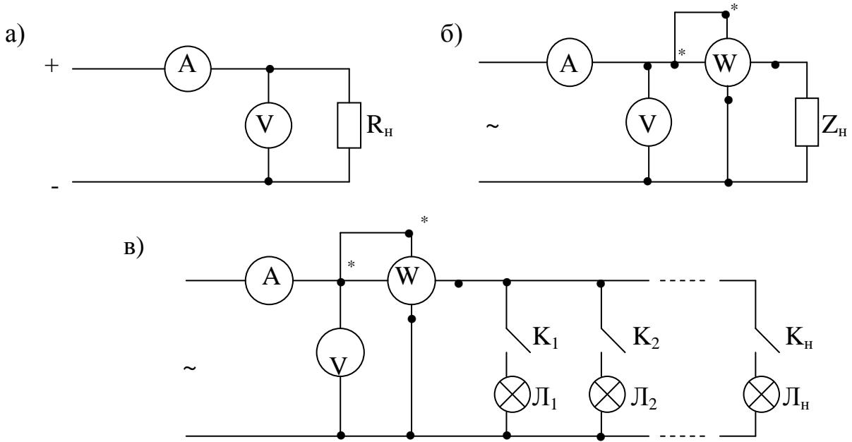
Обозначения на рисунках: А – амперметр, В – вольтметр, В – ваттметр,  $Z_H$  – нагрузка,  $L_1$ ,  $L_2$ , ...,  $L_n$  – в качестве нагрузки использованы лампы накаливания,  $K_1$ ,  $K_2$ , ...,  $K_n$  – выключатели.
