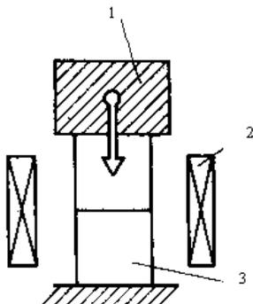
**Рис. 9.1. Схема диффузионной сварки свободным деформированием:**
