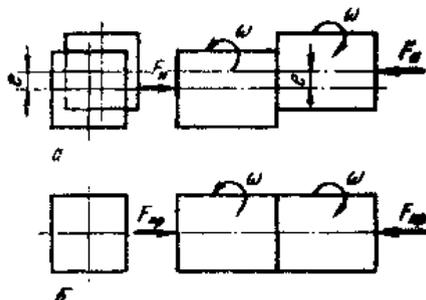
**Рис. 11.3. Схема орбитальной сварки трением:**
