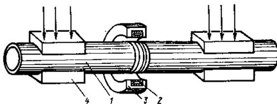
**Рис. 14.3. Схема стыковой высокочастотной сварки труб:**
