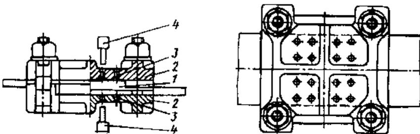
**Рис. 8.3. Схема сварки с предварительным зажатием свариваемых деталей в кондукторе.**
