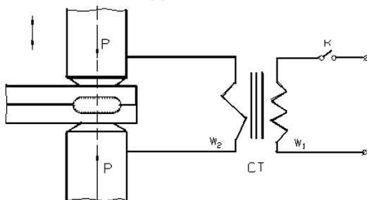
Рис. 6.1. Схема точечной контактной сварки.
