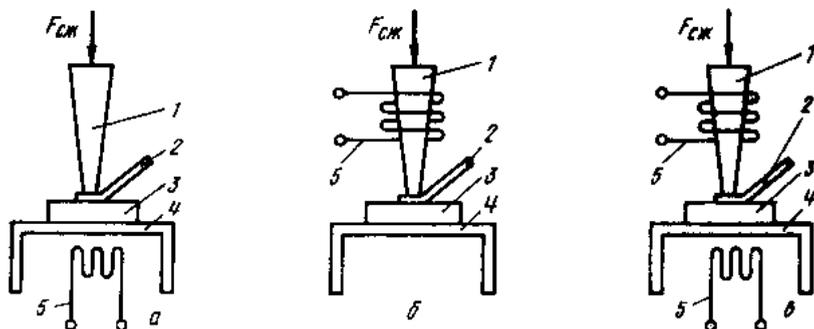
Рис. 12.2. Разновидности термокомпрессии в зависимости от способа нагрева:
