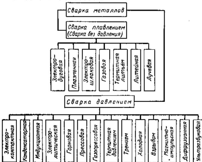
**Рис. 1.2. Классификация способов сварки.**
