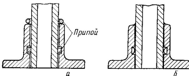
**Рис. 18.2. Схема капиллярной пайки:**
