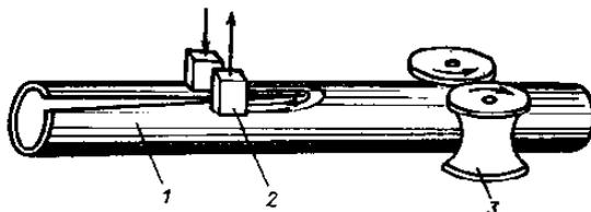
**Рис. 14.1. Схема кондуктивного токоподвода при непрерывной высокочастотной стыковой сварке:**
