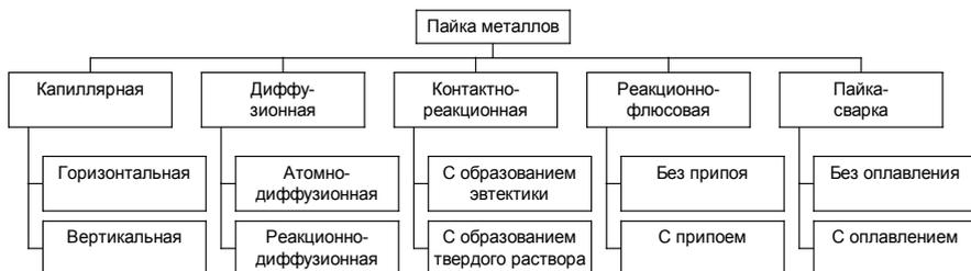
Рис. 18.1. Классификация методов пайки
