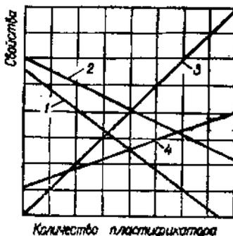
**Рис. 21.1.** Изменение механических свойств полимера в зависимости от количества пластификатора: 1 - прочность на сжатие, 2 - прочность на разрыв, 3 - прочность на удар, 4 - относительное удлинение.
