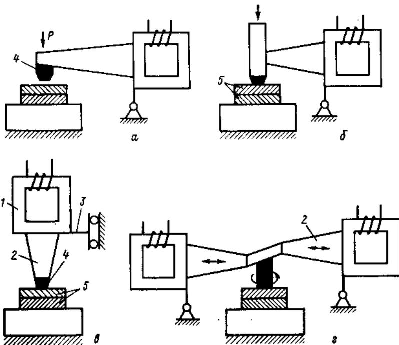
**Рис. 10.1. Схема типовых колебательных систем для ультразвуковой сварки металлов:**
