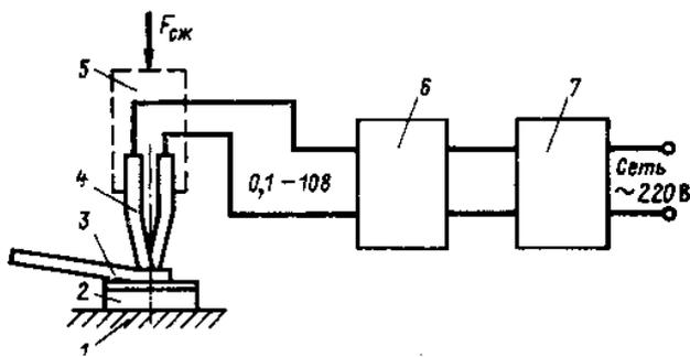
**Рис. 12.1. Схема сварки давлением с косвенным нагревом:**
