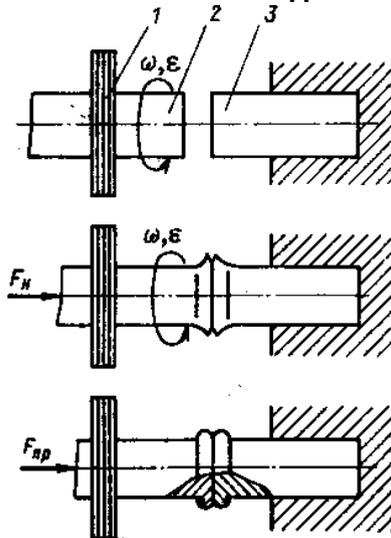
**Рис 11.2. Схема инерционной сварки трением:**
