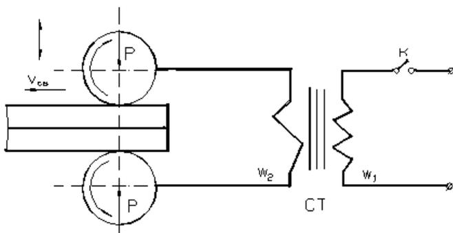
**Рис. 6.2. Схема шовной контактной сварки.**
