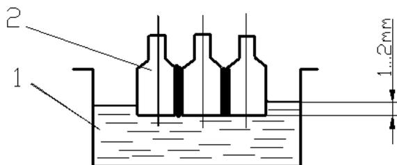
**Рис. 19.4. Схема пайки погружением в расплавленный припой:**
