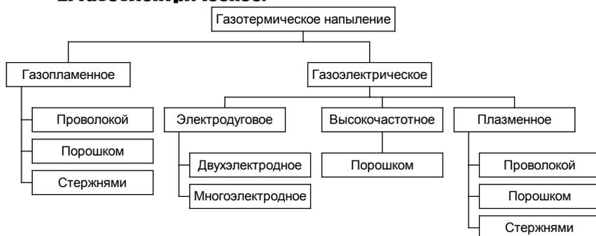
**Рис. 17. 1. Классификация видов газотермического напыления.**
