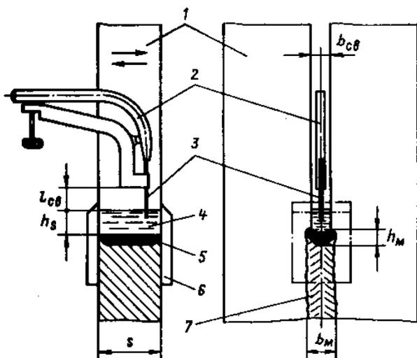
**Рис. 3.2. Схема электрошлаковой сварки:**
