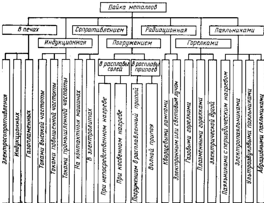
**Рис 19.1 Классификация способов пайки.**
