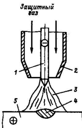
**Рис. 1.**Схема процесса сварки в среде защитных газов неплавящимся электродом:
