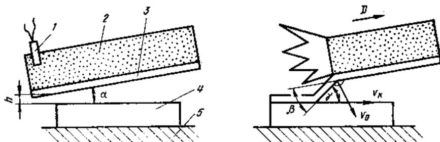
**Рис. 13.3. Схема сварки взрывом под углом:**
