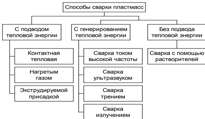
**Рис. 23.1. Классификация способов сварки пластмасс.**
