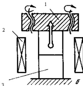
**Рис. 9.2. Схема диффузионной сварки принудительным деформированием:**
