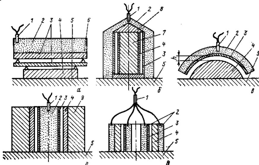
**Рис. 13.4. Технологические схемы и оборудование для сварки взрывом:**
