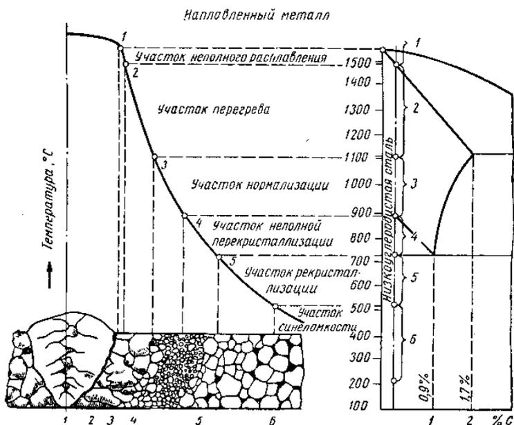
**Рис. 1.1. Строение сварного шва после затвердевания и распределения температуры малоуглеродистой стали в зоне термического влияния.**
