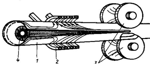
**Рис. 14.2. Схема индуктивного токоподвода при непрерывной высокочастотной стыковой сварке:**
