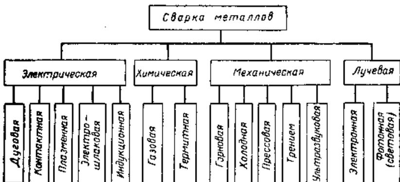
**Рис. 1.3.** Энергетическая классификация процессов сварки.
