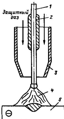
**Рис 2. Схема процесса сварки в среде защитных газов плавящимся электродом:**
