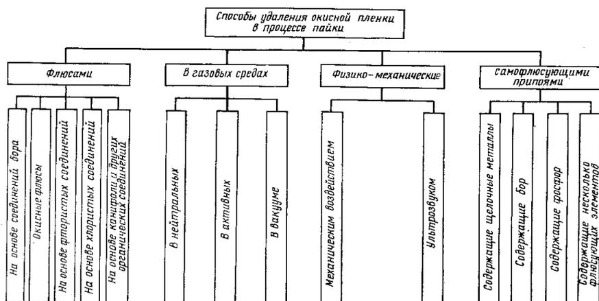
**Рис. 20.1. Способы удаления окисной пленки в процессе пайки.**
