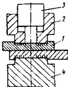
**Рис. 8.4. Схема точечной сварки с односторонним деформированием свариваемых деталей.**
