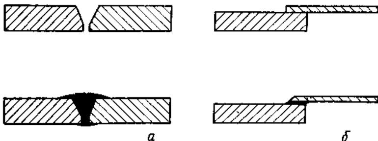
Рис. 18.4. Схема образования шва при пайке-сварке:
