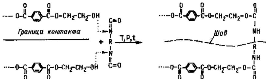
Рис 23.2. Механизм химической сварки ПЭТ при помощи диизоцианата.
