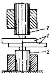
Рис. 8.1. Схема сварки без предварительного зажатия свариваемых деталей.
