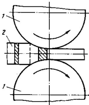
**Рис. 13.1. Схема сварки прокаткой:
