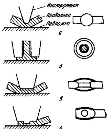
**Рис. 12.4. Основные типы термокомпрессионных соединений в зависимости от формы применяемого инструмента:**
