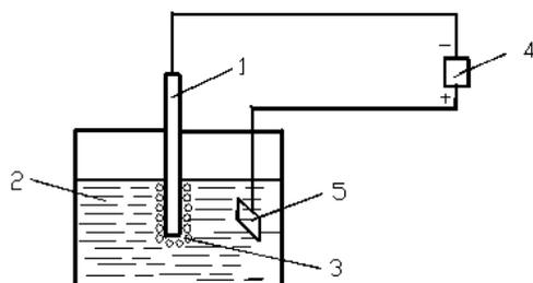
**Рис. 19.3. Принципиальная схема пайки сопротивлением:**
