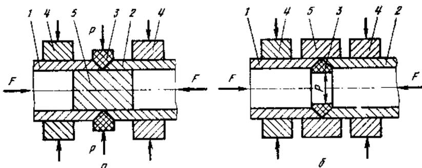
**Рис. 11.4. Схема радиальной сварки трением:**
