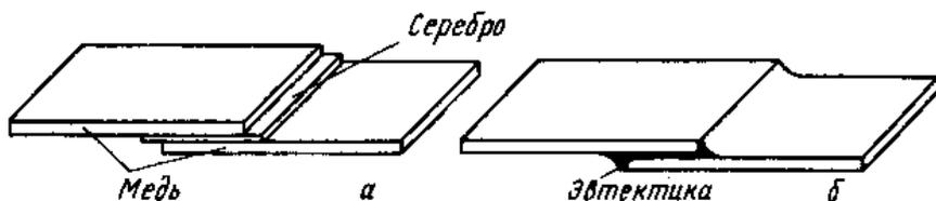
Рис. 18.3. Схема контактно-реактивной пайки:
