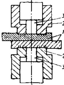
**Рис. 8.2. Схема сварки с предварительным зажатием свариваемых деталей.**
