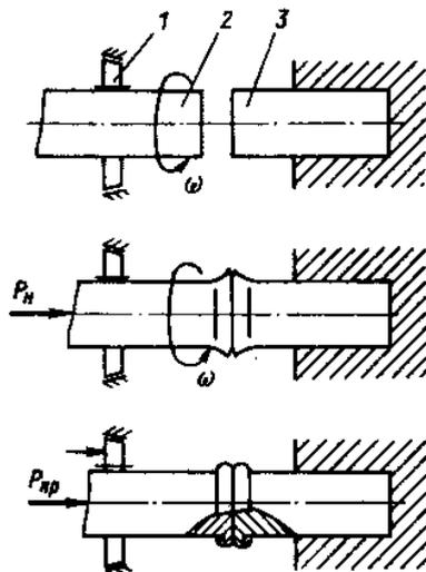
**Рис. 11.1. Схема сварки трением с непрерывным приводом:**
