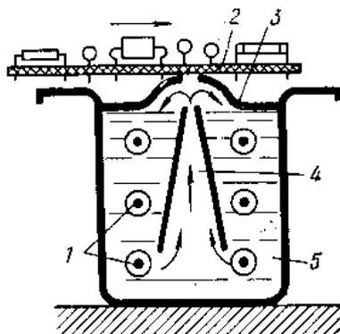
**Рис. 19.5. Принципиальная схема пайки волной припоя.**
