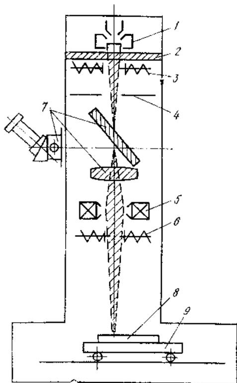
**Рис. 4.1. Схема электронно-лучевой установки**
