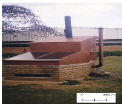
1.3.22-chizma. Biomassa va issiqlik akkumulyatorli quyosh quritkichining umumiy ko'rinishi
