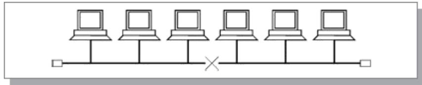
Рисунок 67. Обрыв кабеля в сети с топологией шина
