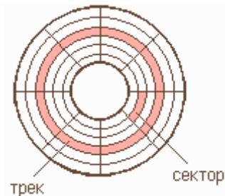
Рисунок 46 . Поверхность магнитного диска.
