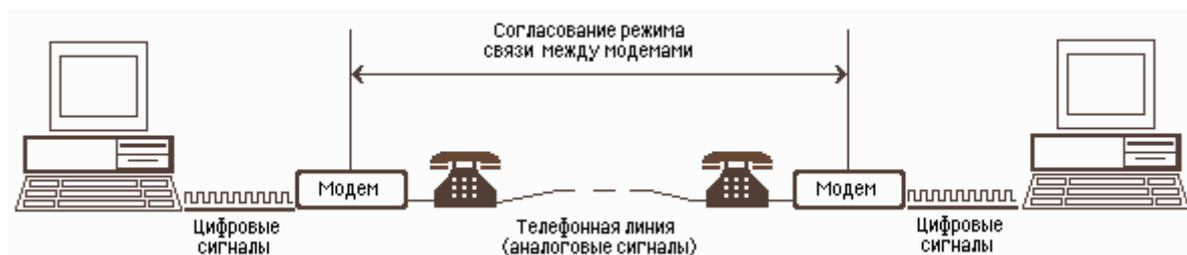
Рисунок 60. Схема реализации модемной связи
