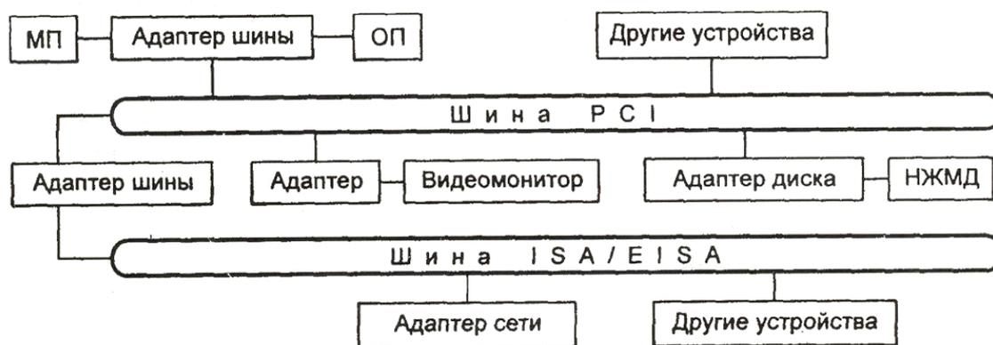
Рисунок 29. Конфигурация системы с шиной PCI
