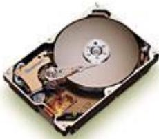
Как и у дискеты, рабочие поверхности платтеров разделены на кольцевые концентрические дорожки, а дорожки — на секторы. Головки считывания-записи вместе с их несущей конструкцией и дисками заключены в герметически закрытый корпус, называемый модулем данных. При установке модуля данных на дисковод он автоматически соединяется с системой, подкачивающей очищенный охлажденный воздух.
