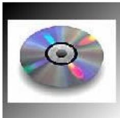
CD-ROM состоит из прозрачной полимерной основы диаметром 12 см и толщиной 1,2 мм. Одна сторона покрыта тонким алюминиевым слоем, защищенным от повреждений слоем лака. Двоичная информация представляется последовательным чередованием углублений (pits — ямки) и основного слоя (land — земля).
