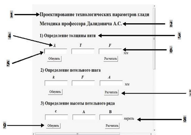
17-расм. Трикотаж тўқималари технологик кўрсаткичларини ҳисоблашга мўлжалланган фойдаланувчи дастурий комплексининг интерфейси таркибий тузилиши
