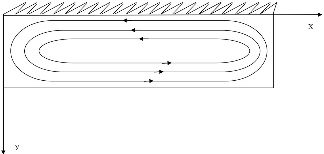
Рис.3. Вихревые токи в образце с пилообразной структурой.
