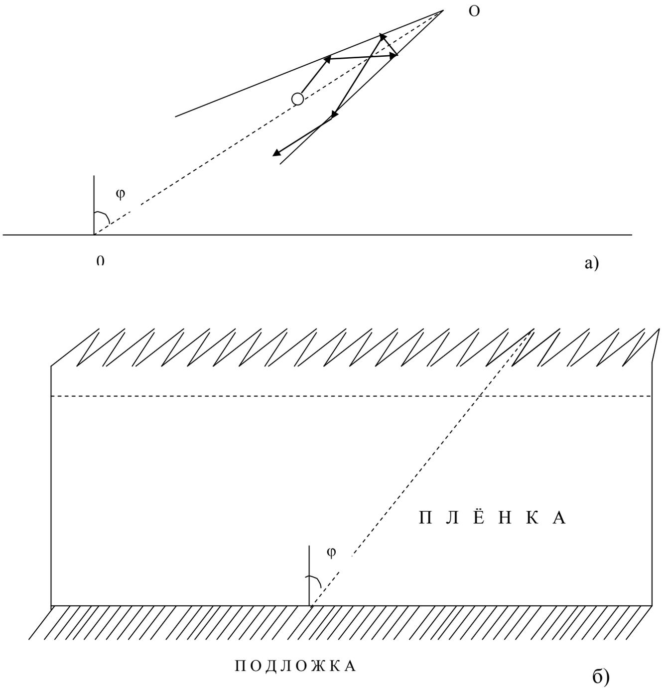
Рис.2. Схематическая модель пленки с пилообразной зубчатой структурой.
