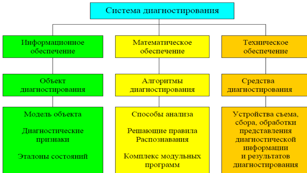
Рис. 4.2. Элементы системы диагностирования технического состояния механизмов
