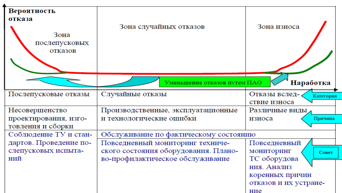
Рис. 4.1. Схема реализации программы обеспечения надежности функционирования оборудования
