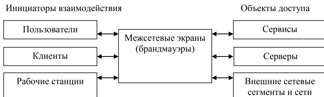
Рис.5 Схема контроля потока сообщений
