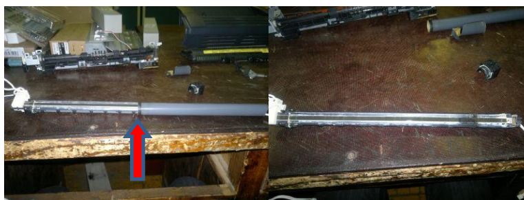
2.19-расм. Эски термопленка олиб ташланиш жараёни.
