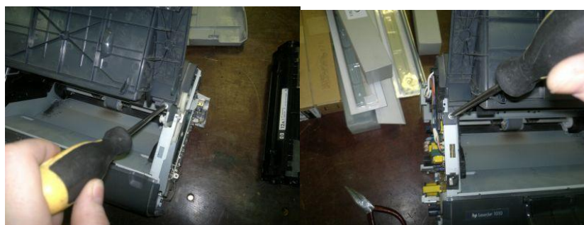
2.10-расм. Принтернинг асосий қопқоғини ечиш жараёни.
