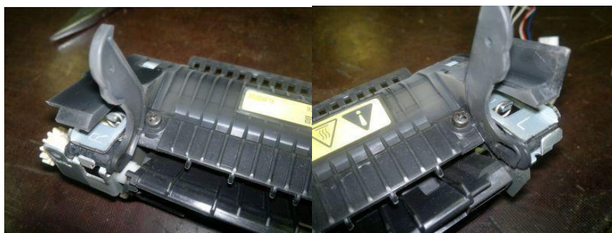
2.14-расм. Печкани асосий қопқоққа улаб турувчи ричаглар.
