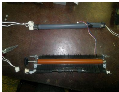
2.17-расм. Термопленка қиздирувчи элементдан ажратилган.
