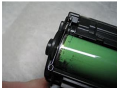
2.23-расм. Картриджнинг икки қисми орасидаги масофани сақлаб турувчи пружина.
