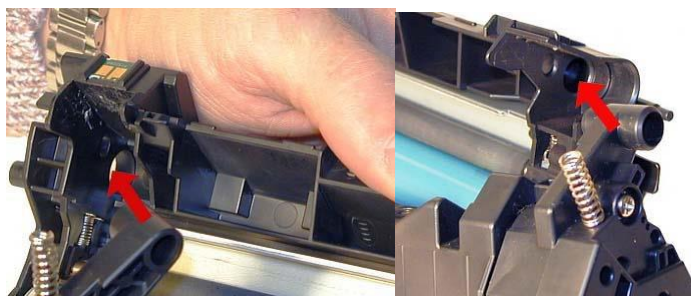
2.40-расм.Картридж икки қисми бирлаштириб турувчи ўқлар жойлашуви.
