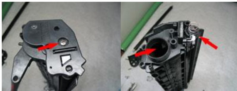
2.30-расм. Тонер сақлвнувчи бункер.
