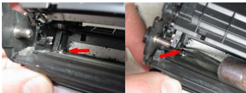
2.28-расм. Картридж қисмларини ушлаб турувчи штифтлар.
