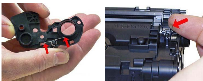
2.41-расм. Барабан қопқоғини ҳарактлантирувчи пружина.
