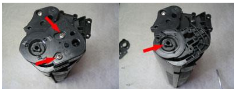
2.24-расм. Барабан ўқини ушлаб турувчи қопқоқ.
