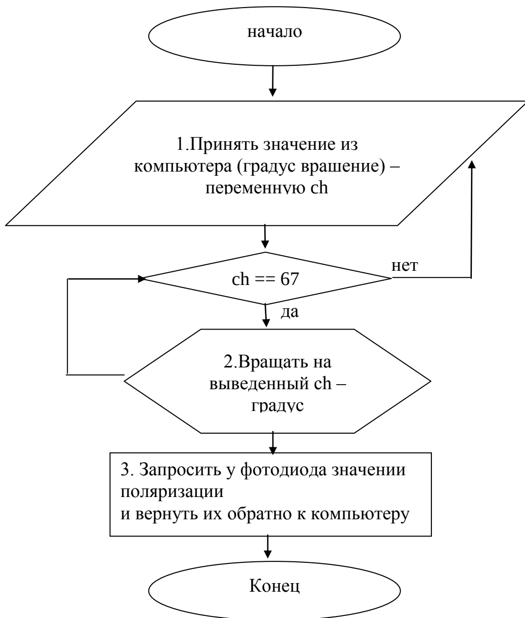
Рис. 3.6. Алгоритм работы программы микроконтроллера
