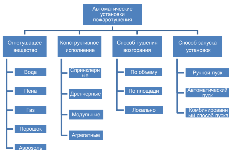
Рис.3.1. Классификация автоматических установок пожаротушения
