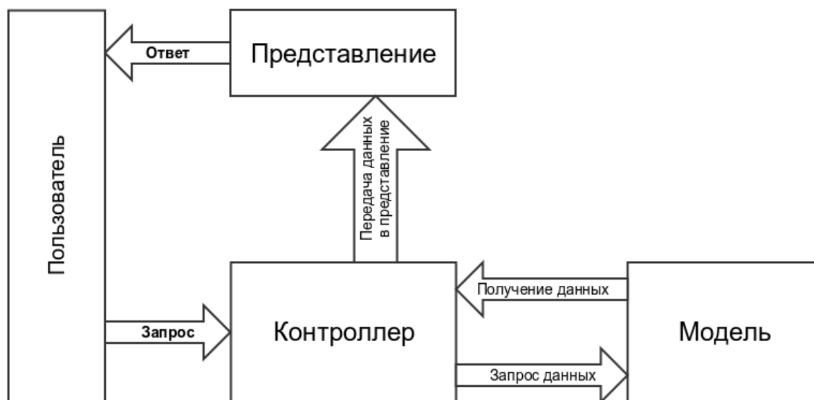
Рис.2.8. Механизм работы MVC
