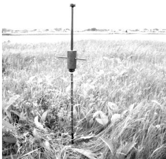
Рис. 1. Динамическое зондирование грунта с помощью ударника «СоюздорНИИ».
