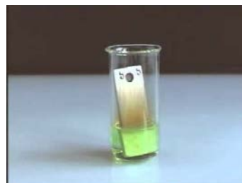
Temirning konsentrlangan nitrat kislota ta‘siridan passivlashishi
