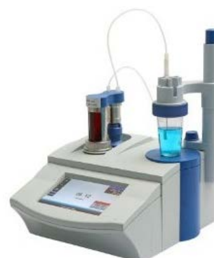
Avtomatik titrlash asbobi
