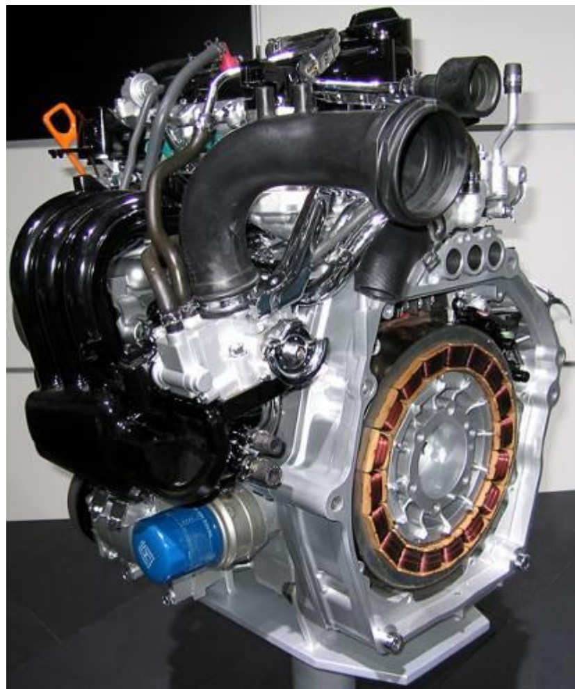
1.13-rasm. HONDO firmasining gibrid kuch qurilmasi.
