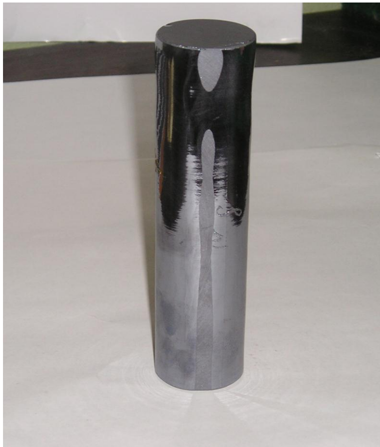
8-расм. Чохралский усули билан устирилган монокристалл кремний . Диаметри-40мм. солиштирма каршилиги-1,1-1,5 Ом.см, кристаллографик йуналиши-(111)
