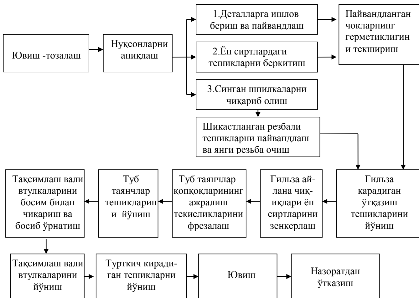
2-rasm. Slindrlar blokini tiklash jarayonining blok-sxemasi (1-3 tiklash yo'nalishlari)
