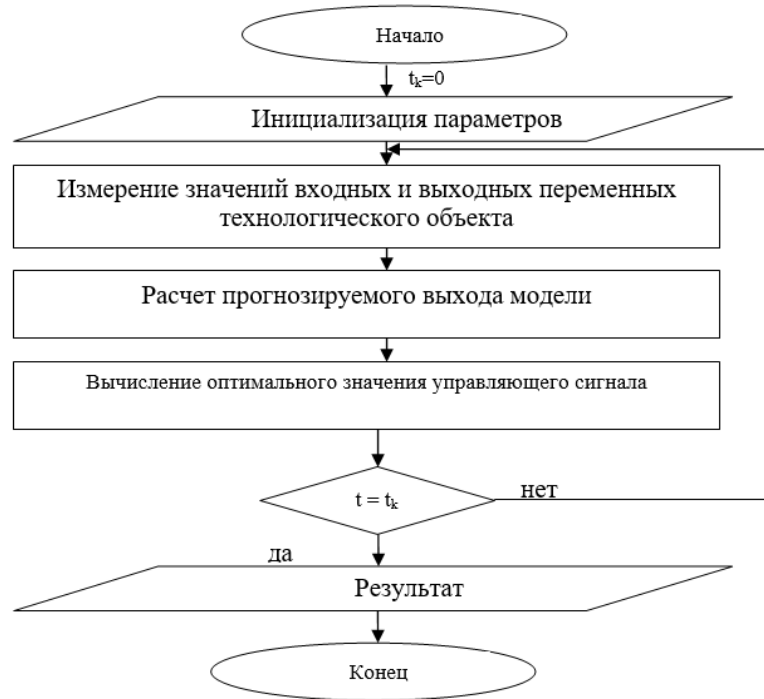
Рис. 2. Алгоритм нейро-нечеткого прогнозирующего регулятора
