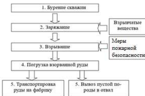
Рис.1 Схема технологического процесса на золотоизвлекательных горнорудных карьерах
