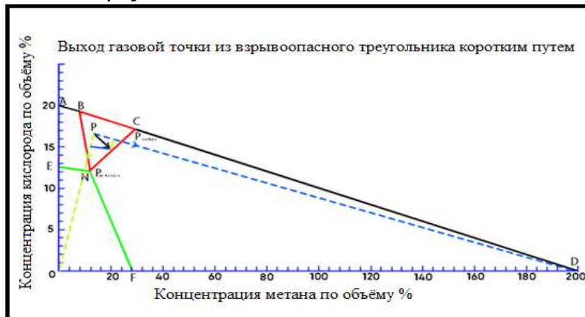
Рис. 6. Выход газовой точки из взрывоопасного треугольника коротким путем.
