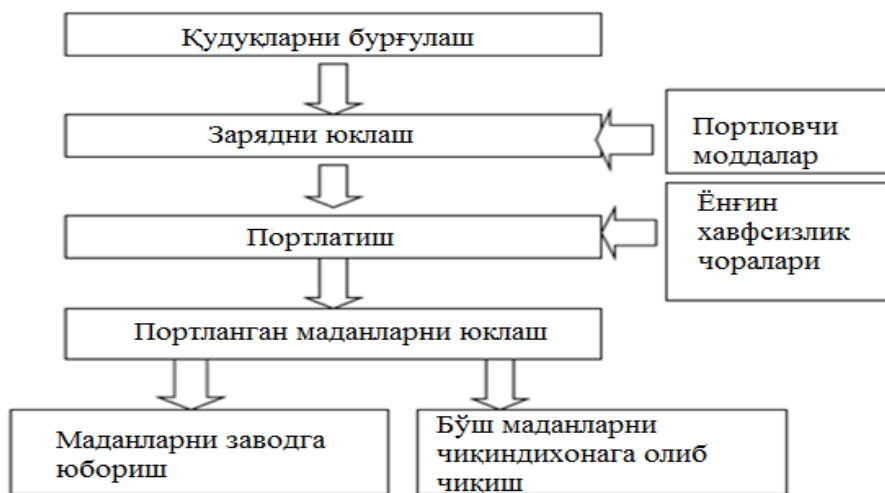
1 - расм. Очик конларда олтин қазиб олишнинг технологик жараёни схемаси.
