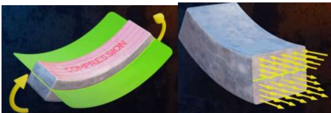
2-rasm. Sterjen ko'ndalang kesimida kuchlanishlarni taqsimlanishi.
