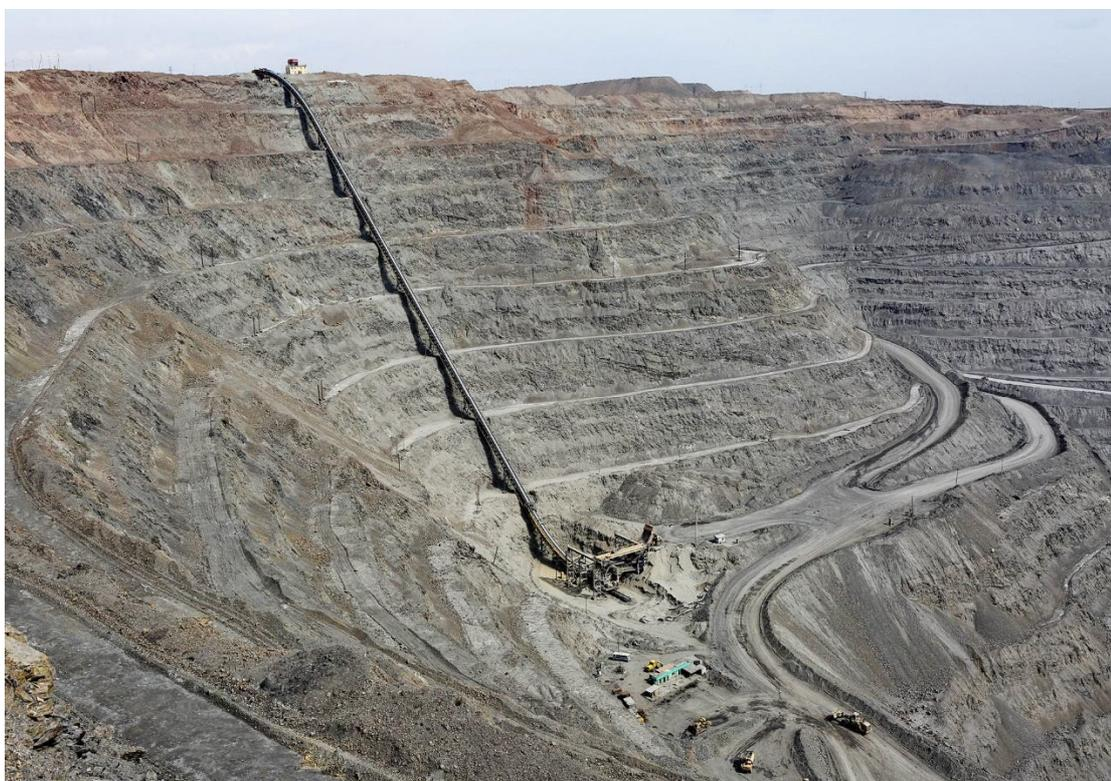
**Комплекс КНК-270 (крутонаклонный конвейер Мурунтау)**
