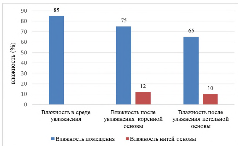
Рис.11. Влажность нитей основы на ткацком станке.
