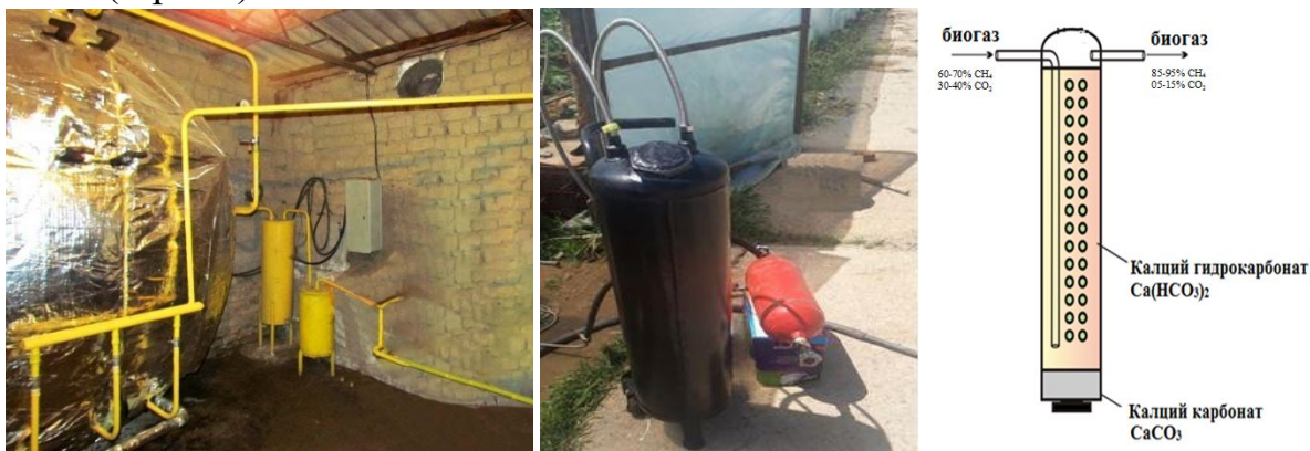
3-расм. Биореактор ва экспериментал қурилманинг фотосурати ва схемаси
