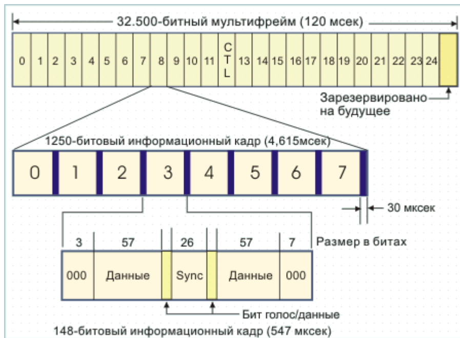
Рис. 1.3. Структура кадров в GSM
