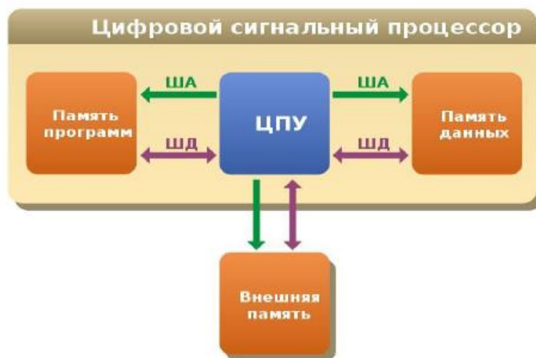
Рис.2.2. Обобщенная структура цифрового сигнального процессора
