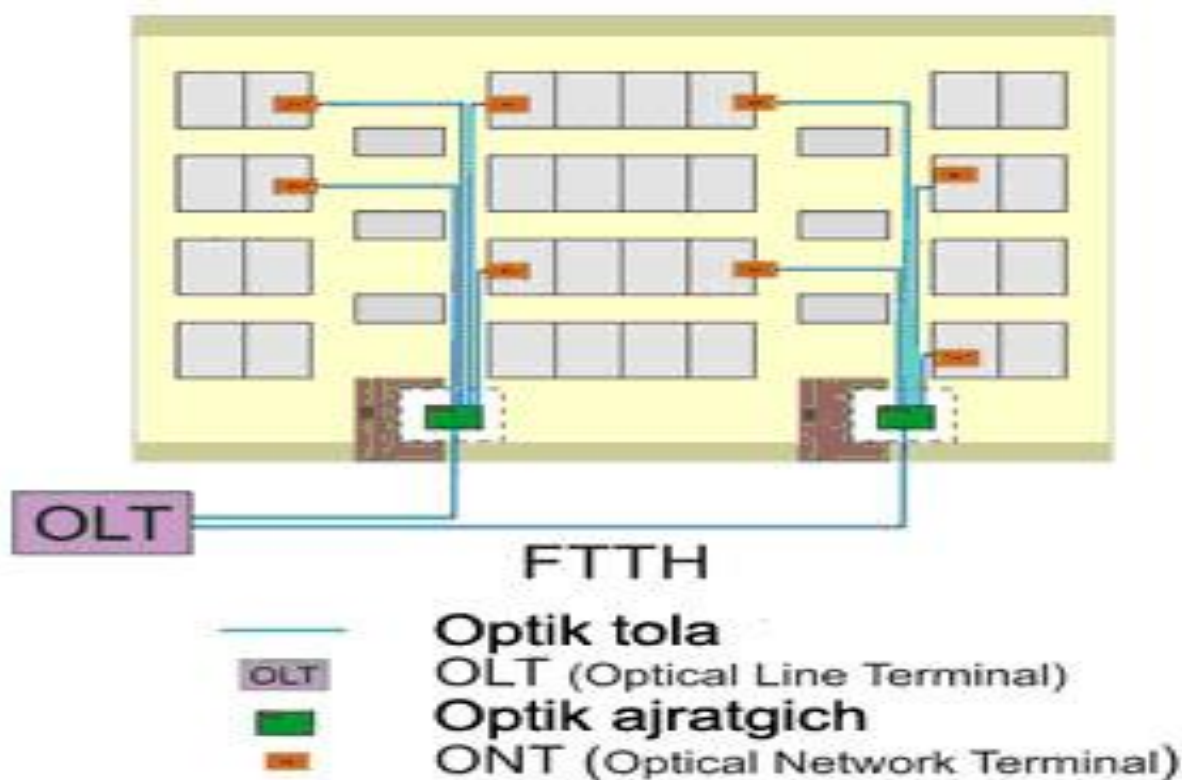
2-rasm. FTTH texnologiyasini tashkil qilish sxemasi
