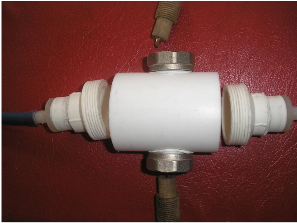
рис.4.4. Измерительный модуль ИПВ в разобранном виде
