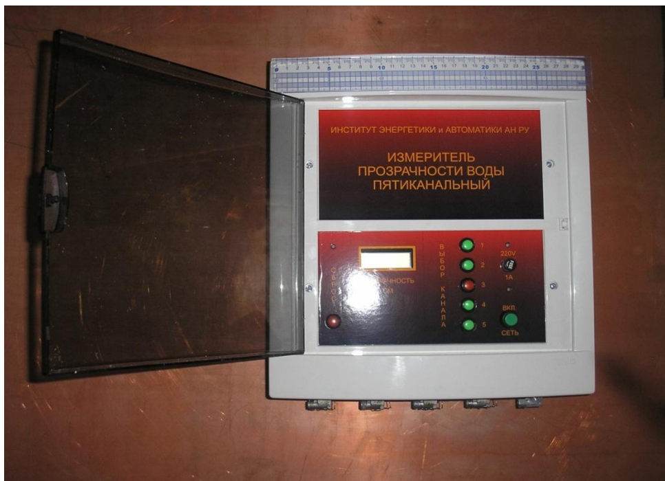
Рис.4.6. Электронный блок измерения, управления и индикации измерителя прозрачности воды ИПВ.
