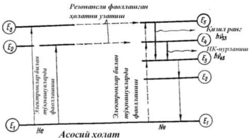
2.9.1-расм. Гелий – неонли лазернинг энергетик сатҳлар схемаси
