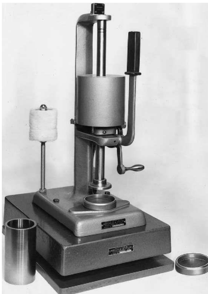
rasm. Qolip aralashmalaridan namunalar tayyorlaydigan koper jihozi
