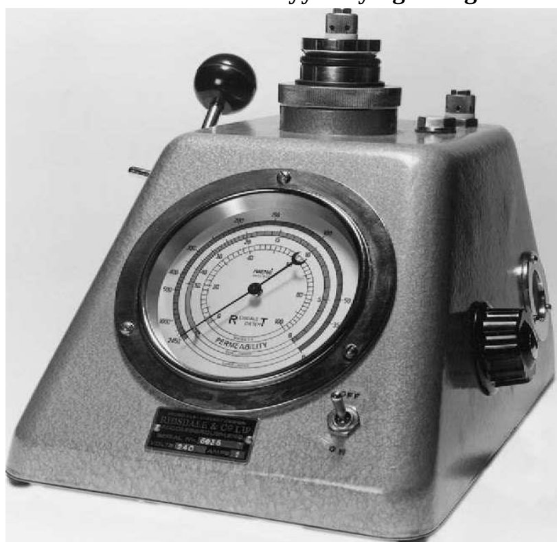
rasm. Qolip aralashmalaridan tayyorlangan namunalarni sinash uchun kompakt jihozi
